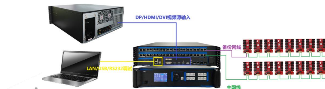
图 4-7-1 单发送卡备份连接图
