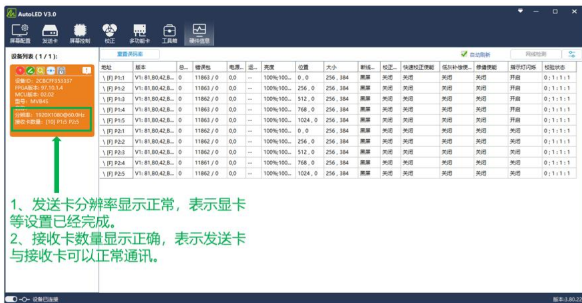
图 3-2 软件与发送卡的通讯状态图
