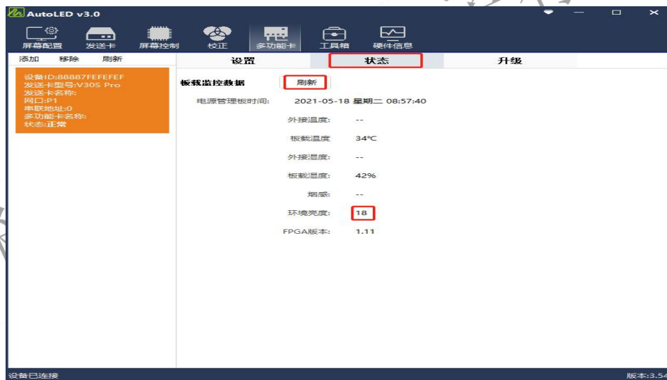
图 7-1-2 多功能卡板载监控数据与接收卡芯片调节环境亮度对照图
